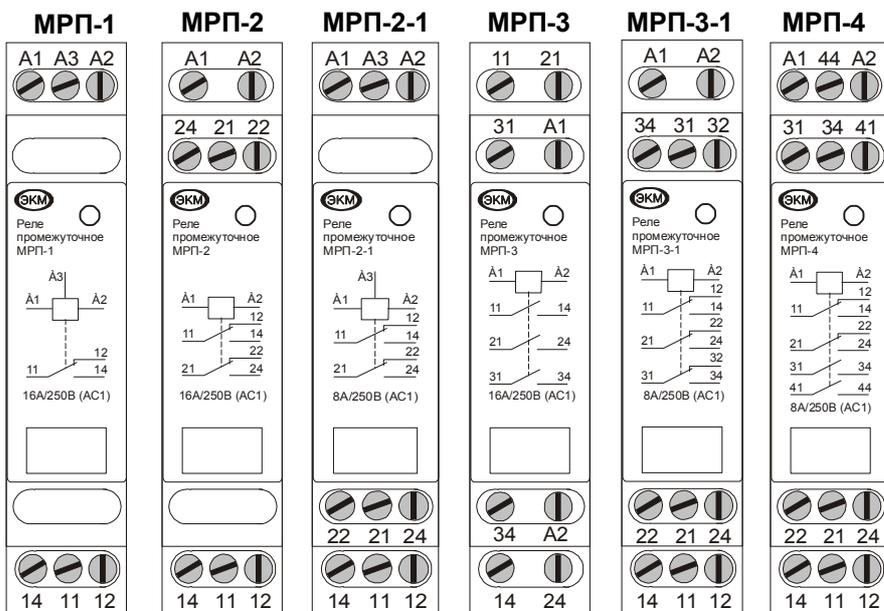
Для реле с напряжением питания ACDC24В/ AC230В напряжения AC230В подаётся на клеммы A1-A2, а напряжение AC24В или DC24В - к клеммам A2-A3 без соблюдения полярности.
